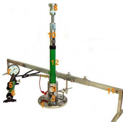
Rys. 1.2. Aparatura VSS z jednopunktowym pomiarem przemieszczenia płyty
